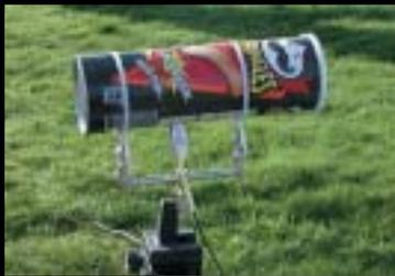
*Caro Marco, abbiamo, sì, parlato di confezione di Pringles ma per dire quanto effettivamente si può fare ed è stato fatto, con qualunque tubo o confezione più o meno di quelle dimensioni. Un'antenna di tipo Yagi e direzionale adatta alle frequenze usate dai sistemi WiFi (oltre i 2 GHz). Fai un salto su <http://www.seattlewireless.net/index.cgi/PringlesCantenna> e ne vedrai delle belle. Torneremo sull'argomento quanto prima e nel frattempo attendiamo, ovviamente tutte le vostre realizzazioni.*
